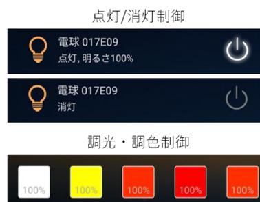
図 3 専用アプリによる IoT 電球の制御
