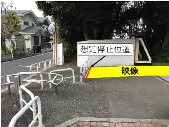
車止めがあると、歩行者が、照射パターンによって止まったか、車止めによって止まったのか、分からないため、車止めを外すことにした。安全確保のため、道路縁石に接した車止めは設置したままとした。
